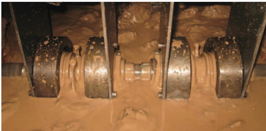
Prüfstand für Schlamm-Gülle-Test
